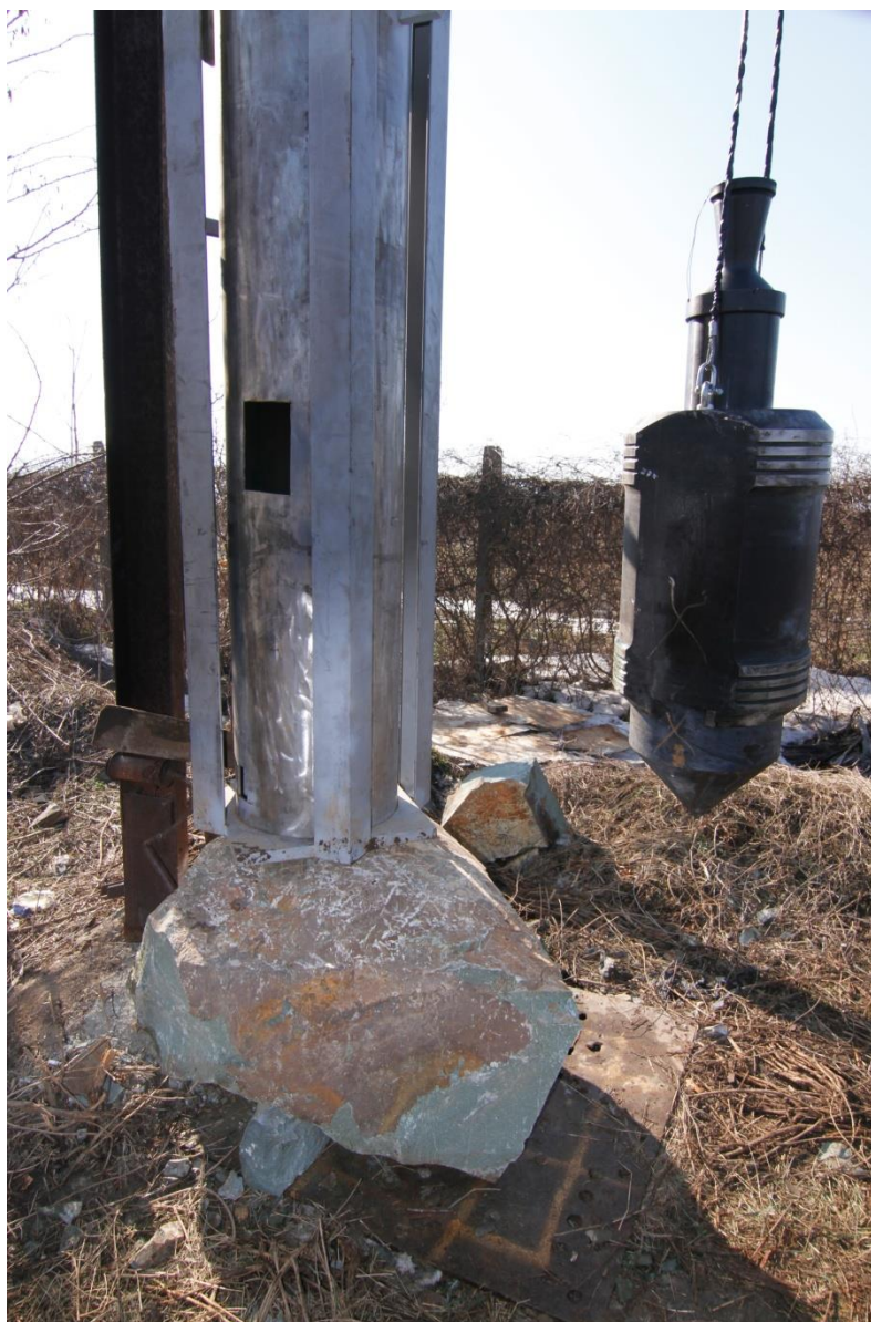
Фиг. 7: Прототипът на Чука поставен върху скален образец и окомплектованата Ударна част с Реактивен двигател и Бойник с форма на конус.
