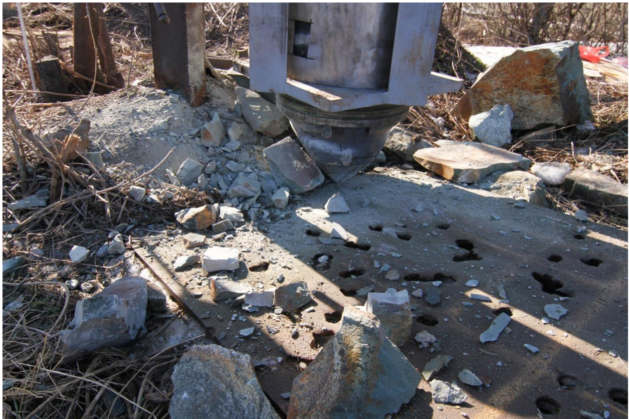
Фиг. 5: Разрушеният скален образец след удар от Ударна част с Бойник-клин.
