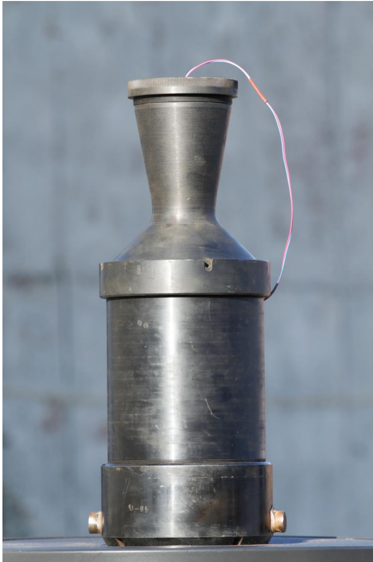
Фиг.1: Реактивен двигател с твърдо гориво модел РД-Т-2000 – подготвен за пуск: зареден и с монтиран електровъзпламенител.
