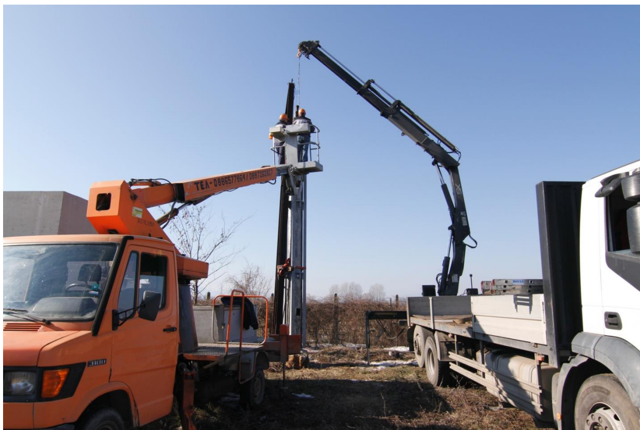
Фиг.4: Автовишка и автокран при подготовката на УЧРС-Е за удар.
