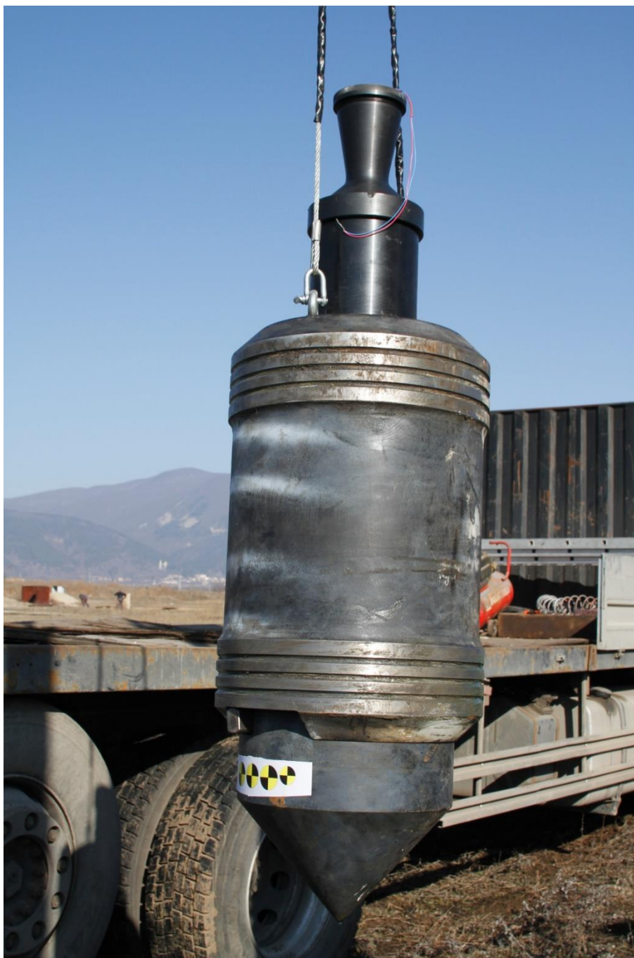
Фиг. 6: Ударна част окомплектована с Реактивен двигател и Бойник с форма на конус.
