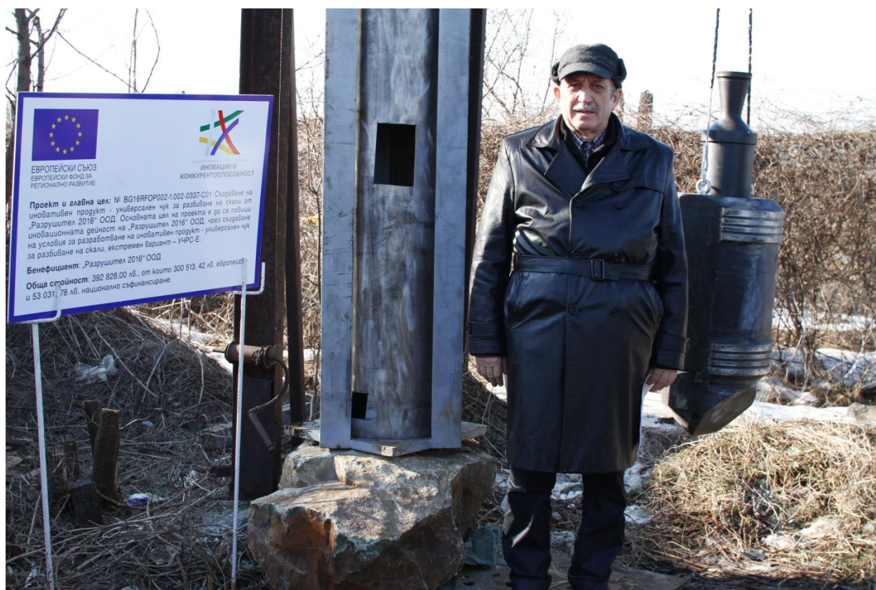
Фиг.2: УЧРС-Е, скален образец и окомплектована Ударна част с клин(преди поставяне в Скелета за удар).
