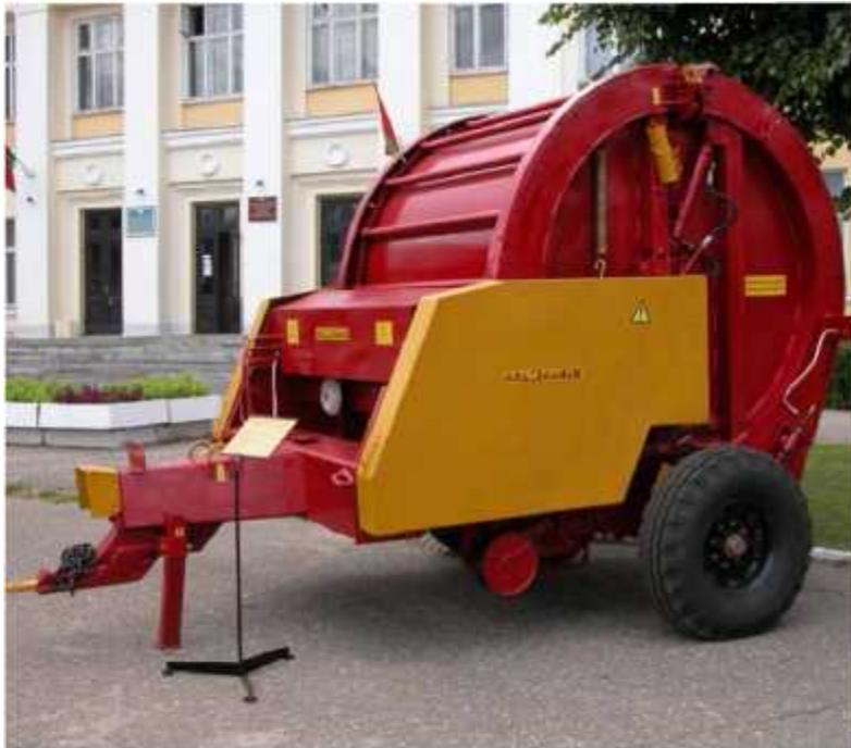
Предназначен для подбора валков сена естественных и сеяных трав или соломы, прессования их в тюки цилиндрической формы (рулоны) с одновременной обмоткой шпагатом. ППР - Ф - 1,8-01 агрегируется с тракторами тягового класса 2.
