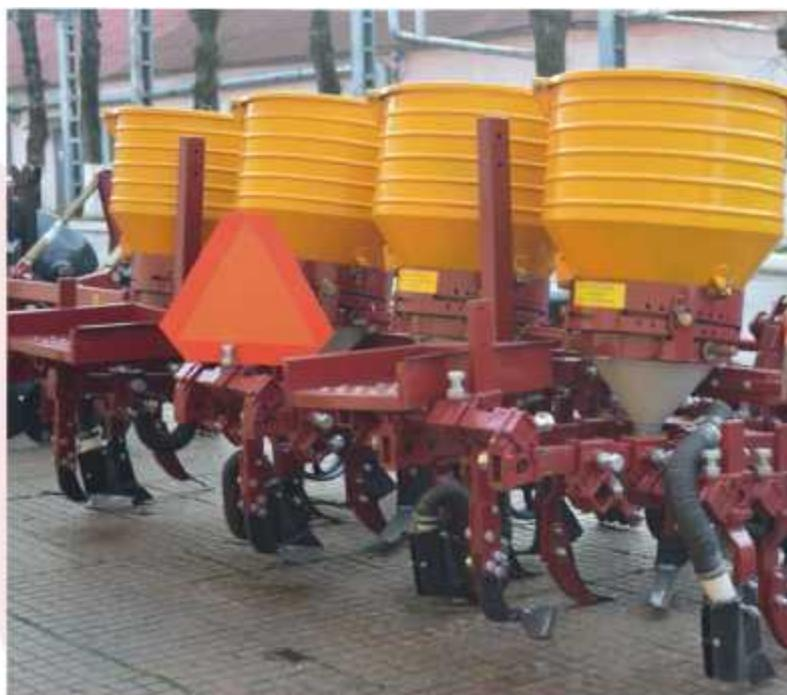
Предназначен для междурядной обработки хлопчатника и других высокостебельных культур в период вегетации, посеянных 4-рядными сеялками.
