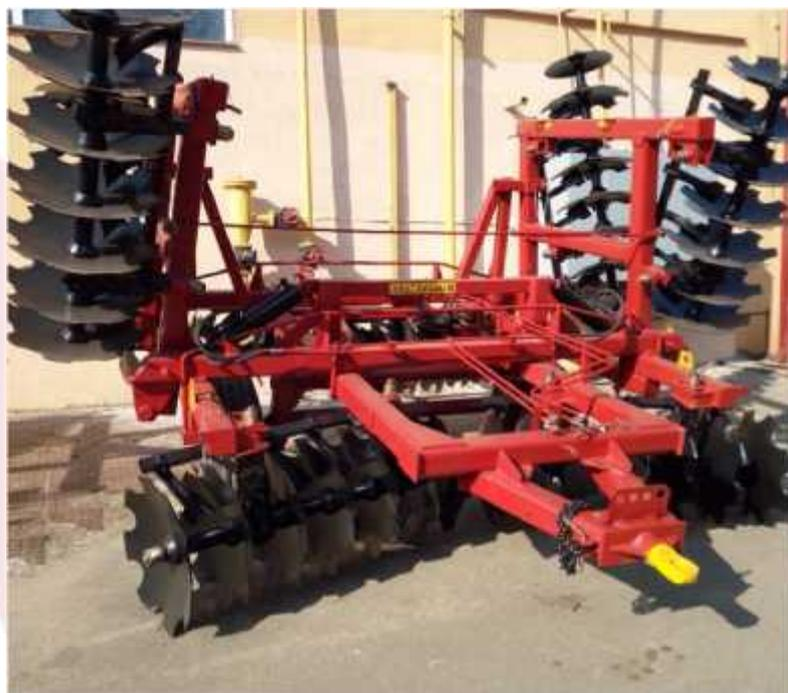
Предназначена для лущения стерни и предпосевной обработки почвы. Борона может использоваться в любых почвенно-климатических зонах.
