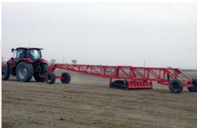
Планировщик полей предназначен для предпосевной и текущей планировки земель, предварительно очищенных от каменистых включений и древесных остатков.
