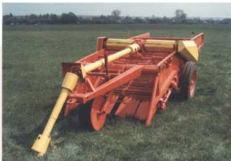
Картофелекопатель предназначен для выкапывания картофеля, частичного отделения клубней с почвы и укладывания их на поверхность поля для дальнейшей подборки.
