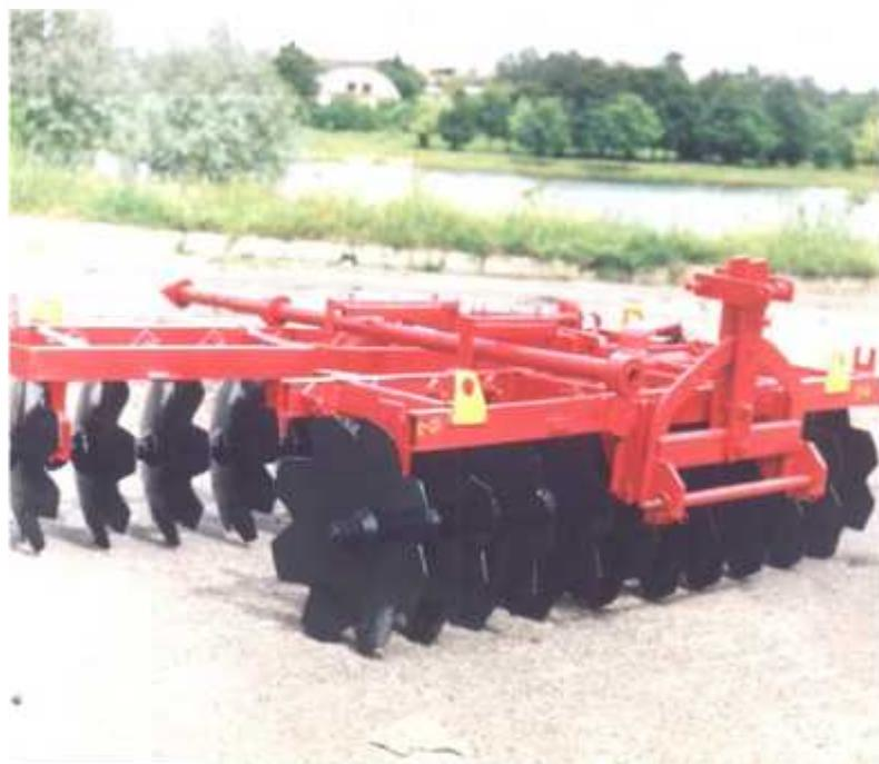
Предназначена для глубокого рыхления почвы и уничтожения сорняков в междурядьях садов. В рабочем положении борона является прицепным орудием, а для дальнего транспортирования переналаживается и навешивается на трактор. Борона может использоваться для сплошной обработки полей. Борона не предназначена для работы на каменистых почвах.
