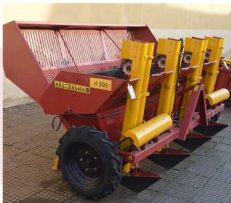
Предназначена для рядковой посадки непророщенных клубней картофеля. Картофелесажалка состоит из следующих основных узлов: рамы, опорно-приводных колес, высаживающих аппаратов элеваторного типа, сошников, бороздозакрывателей, загрузочного бункера и редуктора изменения густоты посадки. Машина проста и удобна при обслуживании и регулировках.
