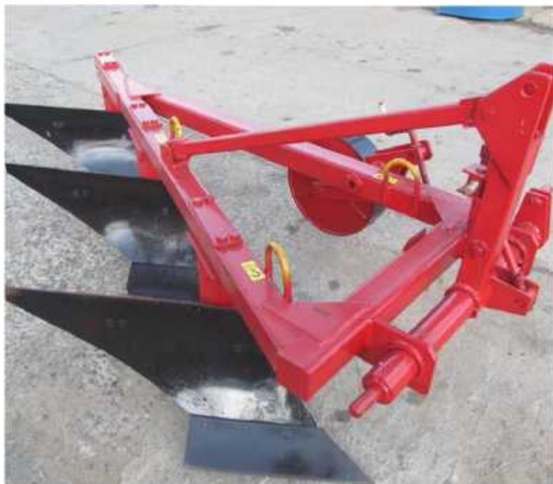
Предназначен для вспашки различных почв с удельным сопротивлением до 0,9 кг/см<sup>2</sup>, под зерновые и технические культуры во всех почвенно-климатических зонах. Агрегатируется с тракторами тягового класса 1,4.
