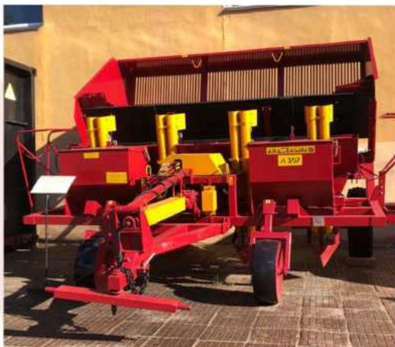
Картофелесажалка предназначена для рядковой посадки непророщенных клубней картофеля с междурядьями 70, 75 или 90 см. Картофелесажалка агрегируется с тракторами тягового класса 1,4. Загрузка картофелесажалки картофелем производится из любых самосвальных транспортных средств. Картофелесажалка оборудована туковысевающими аппаратами.
