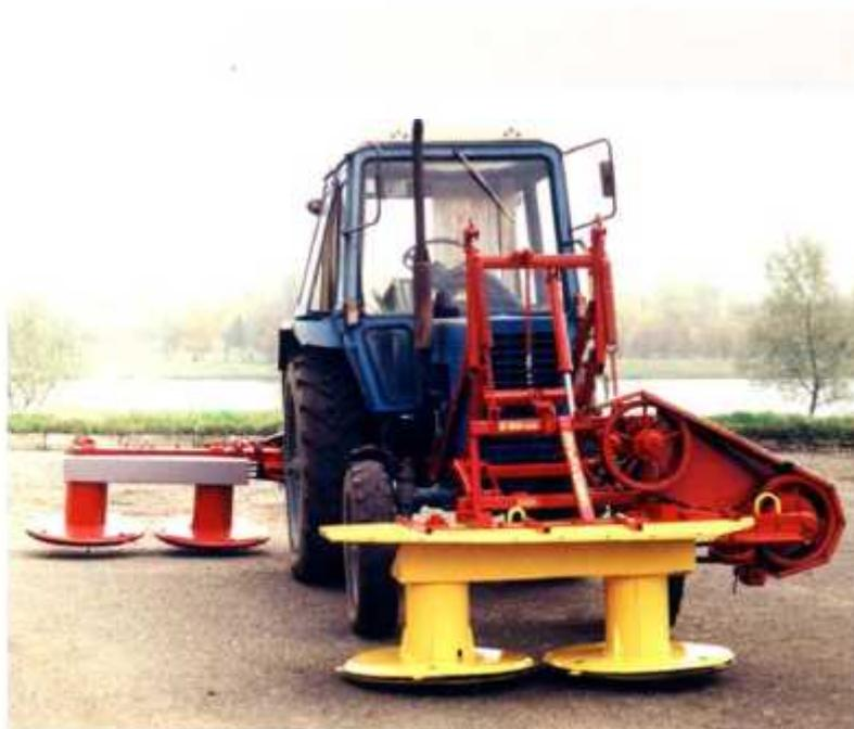
Предназначена для скашивания травы и укладки в прокос между колесами трактора. Агрегатируется с тракторами МТЗ-80/82. Навешивается спереди трактора. Привод от бокового ВОМ.
