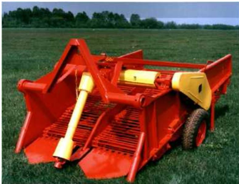
Предназначен для выкапывания картофеля, частичного отделения клубней от почвы и укладывания их на поверхность поля для дальнейшей подборки.
