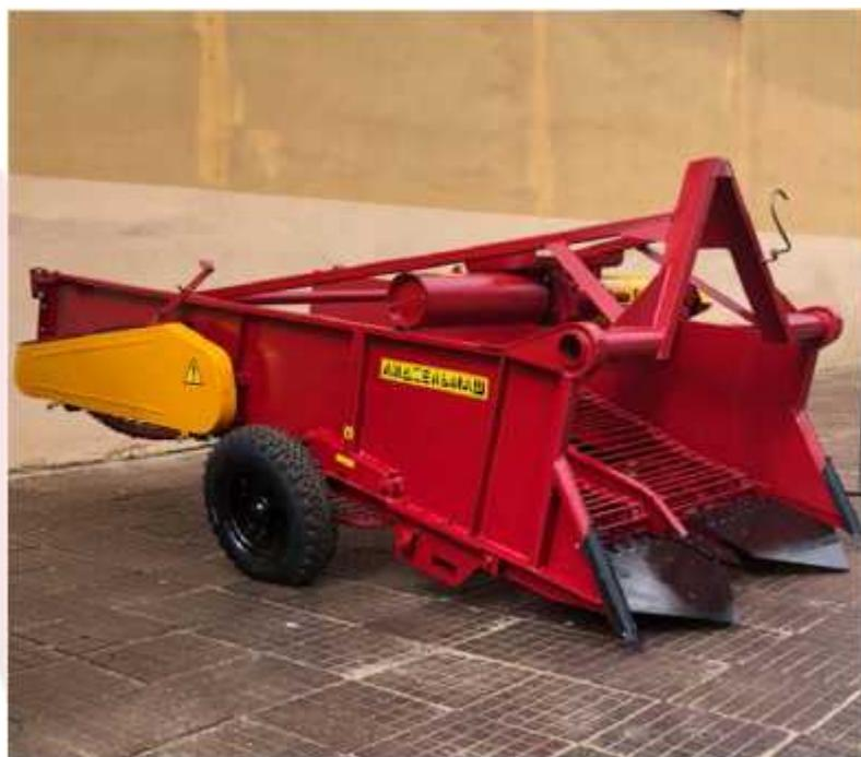
Картофелекопатель с элеваторами на прорезиненных ремнях предназначен для выкапывания картофеля, частичного отделения клубней от почвы и укладывания их на поверхность поля для дальнейшей подборки.
