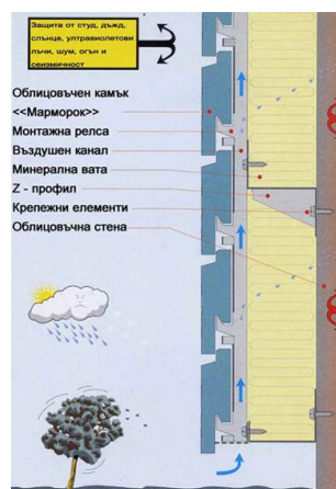
Вентилируема фасадна стена-разрез.
